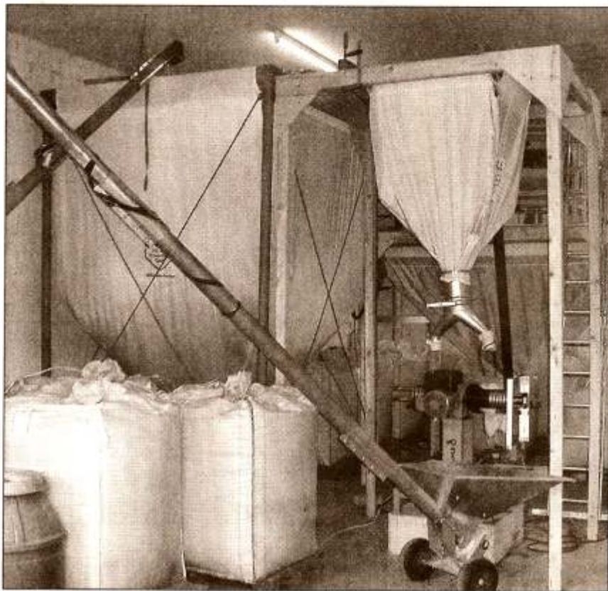
Eigens um Traubenkerne zu mahlen, liess Heini Haubensak diese Mühle erstellen. Hier entsteht das wertvolle Traubenkernöl. (Foto: pd.)
